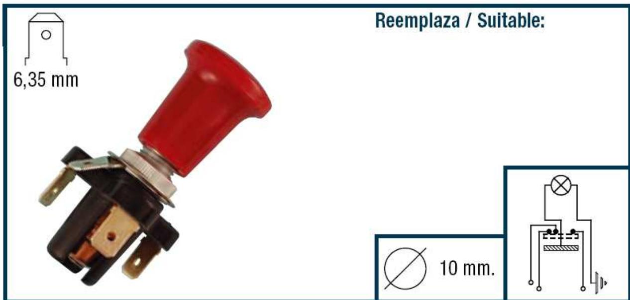
Como vemos, posee cuatro conexiones, siendo la superior la prevista para conexión a masa a fin de proveer de negativo al piloto señalizador. Las otras tres conexiones permanecen abiertas en posición de reposo, y cerradas entre si en posición de trabajo. Esta particularidad la podemos aprovechar conexionando indistintamente cualquiera de las salidas del interruptor a los puntos "I", "D" y "O" del conmutador de dirección.
