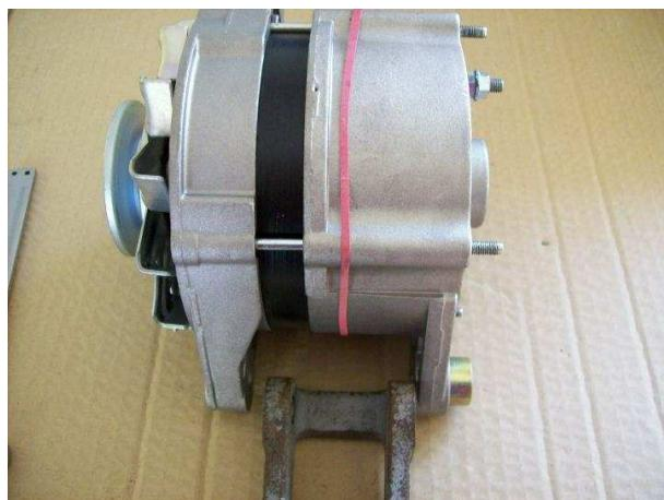
un mismo alternador se pueda montar sobre varios soportes de diferentes medidas, en una de las patas se dispone de un casquillo desplazable para ajustar las separaciones. El soporte a colocar es el propio del alternador FEMSA del 1500.
