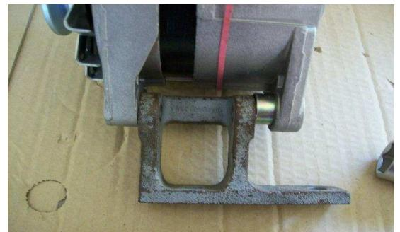
Colocamos los tornillos y montamos el conjunto como habría de ir una vez instalado en el motor, ya con sus tuercas y arandelas
