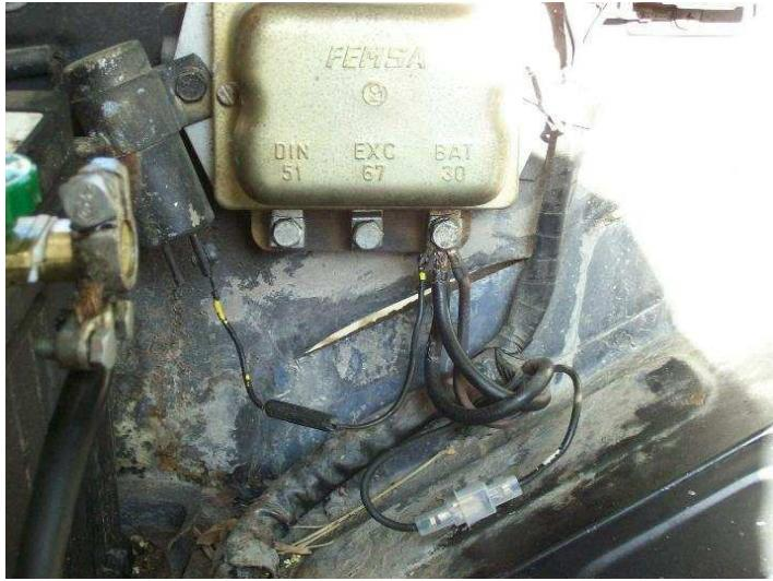
cable que lleva corriente a los servicios que no pasan por contacto. De momento, aprovechamos los dos primeros para intercalar el amperímetro y posteriormente resolvemos el tema de las conexiones aprovechando el borne 30 del regulador para unir en el mismo los tres cables y el condensador antiparasitario. De momento mantenemos el regulador como efecto estético y
