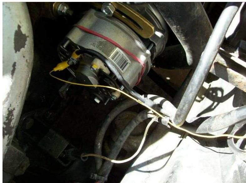
más que las conexiones eléctricas, de manera un poco provisional para comprobar el funcionamiento y luego ya de forma definitiva. El cable amarillo con la pinza es una solución para prolongar la conexión del cable que alimenta el testigo de carga al alternador.
