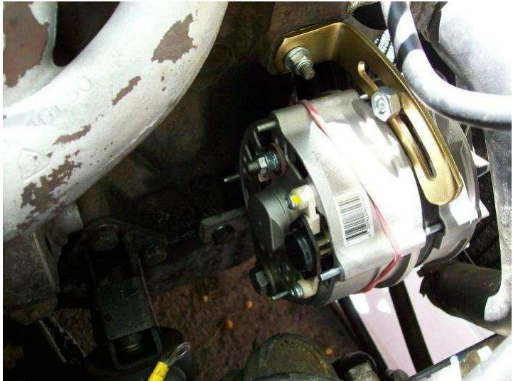
Ya tenemos terminado el trabajo mecánico, y tras la colocación y tensado de la correa, ya no nos queda
