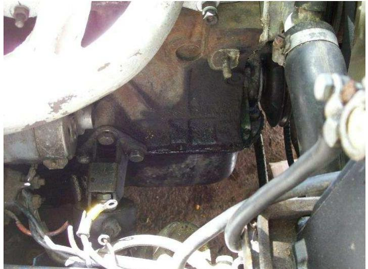
Con el soporte ya colocado ponemos el alternador en la posición que habrá de tener, viéndose que entre tensor y patilla de sujeción tenemos una separación de 10mm. Este pequeño contratiempo se resuelve intercalando una arandela y una tuerca, que además nos vendrá al pelo para dejar fijo el tornillo al alternador, y la fijación definitiva mediante otra tuerca.
