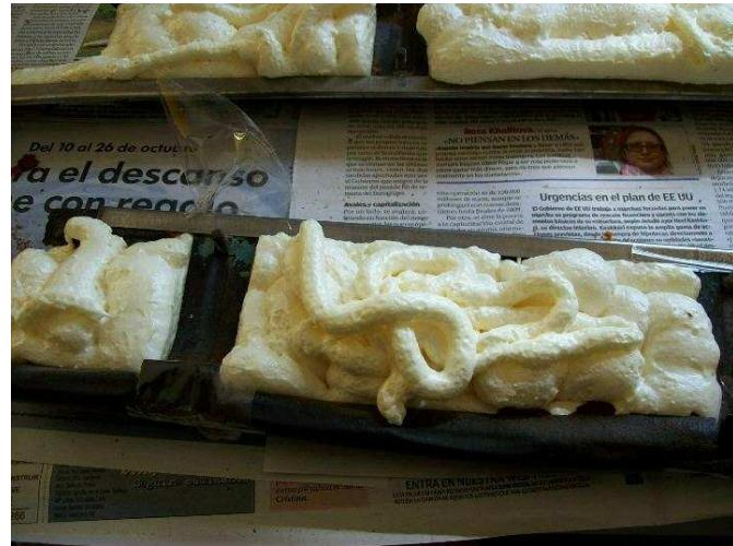
Controlaremos la espuma, y cuando comience a crecer (lo hace entre 2 a 3 veces el volumen inicial), y retiraremos el sobrante que sobresalga por encima de la forma de las chapas, así luego tendremos menos material que cortar. En el bote indica que el “curado” (acción de crecimiento y secado) del producto se realiza en una media hora, pero en la práctica es más tiempo.
