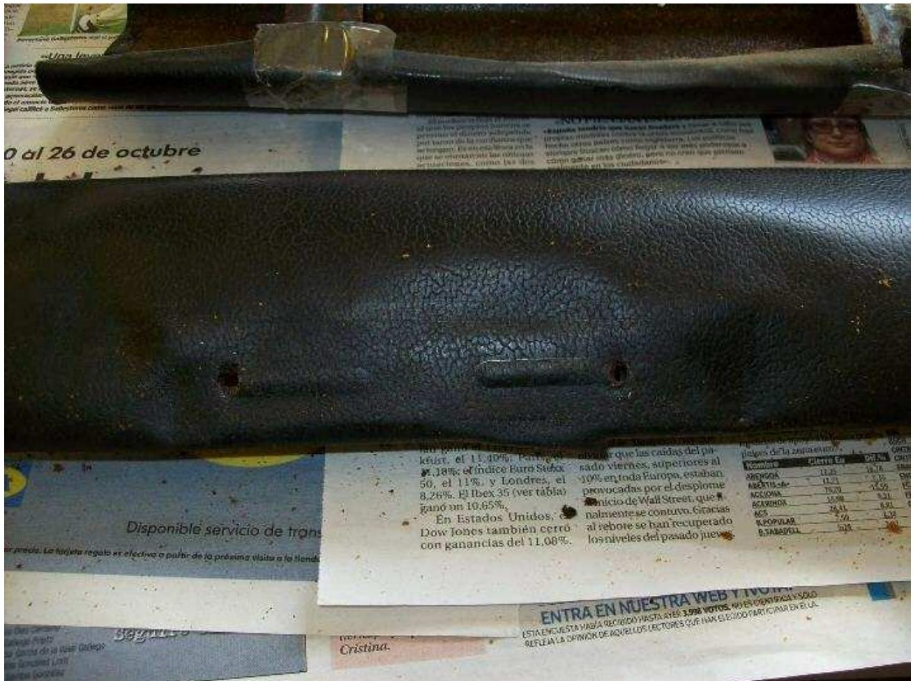
Para remediar esto aplicamos calor con un secador de pelo, y al tomar el material bastante temperatura se vuelve lo suficientemente maleable como para devolverla a su “casi” estado original, presionando con los dedos y dejando enfriar.
