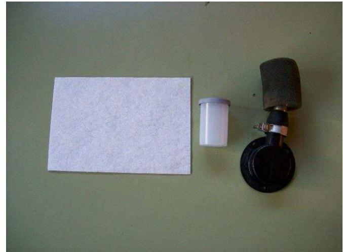
de control hidráulico. Asimismo, un filtro obstruido provoca una merma de la eficacia del servo, al no entrar aire suficiente para contrarrestar el vacío venciendo la resistencia y moviendo el émbolo merced al propio vacío.
