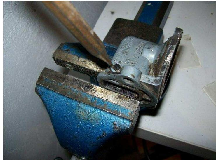
mando. Con un botador desplazamos el eje sin sacarlo, y retiramos la palanca de mando con cuidado que no salte el muelle.
