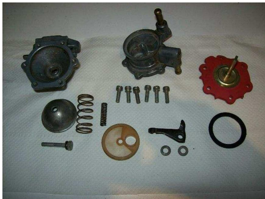
Ya limpias las diferentes piezas y ordenadas, vemos junto a la palanca de mando dos arandelas que en la otra bomba no las llevaba y van colocadas a ambos extremos.
