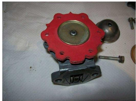
palanca de empuje. Presionamos en el centro de la membrana y una vez ha entrado, giramos esta  $\frac{1}{4}$  de vuelta para que quede anclada a la palanca.
