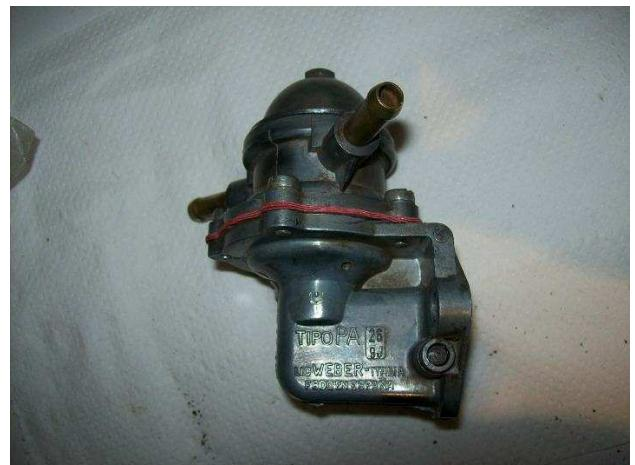
Si soplamos por el tubo de salida, el aire no deberá salir por el tubo de entrada merced a estas válvulas.
