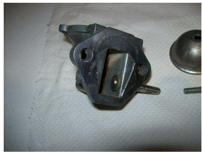
Colocamos el muelle de recuperación y la palanca de mando.
