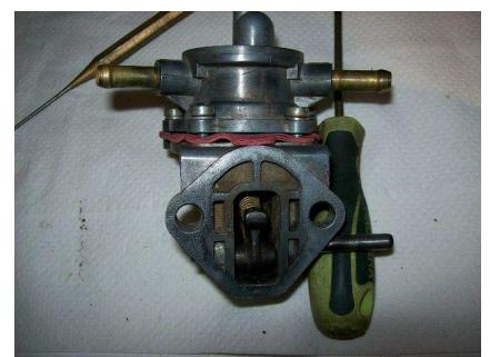
Retiramos el cuerpo superior para comprobar que la membrana queda perfectamente fijada, y presionamos sobre la palanca para ver si actúa, con lo que el montaje del cuerpo inferior queda finalizado.
