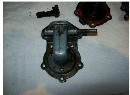
Aquí podemos ver la membrana de recambio junto con la junta de goma de la tapa superior. Ya desmontado todo el conjunto, procuramos que no se pierda nada y procedemos a su limpieza a conciencia.
