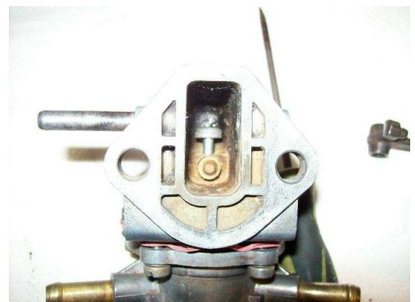
Si colocamos el cuerpo superior, nos permitirá colocar más fácilmente la palanca con su muelle para recuperación. Hecho esto no nos queda más que introducir el eje para seguir el montaje.
