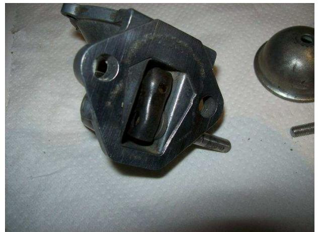
Por último, colocamos la arandela del otro extremo e introducimos el eje, quedando finalizado el montaje del cuerpo inferior.
