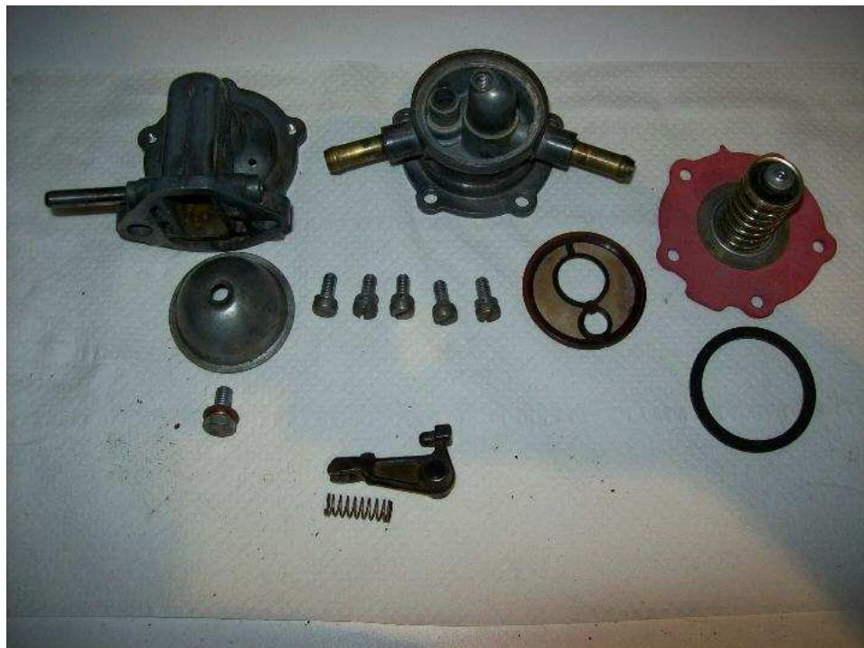
Para el montaje, colocamos primeramente la membrana, y vemos que si empujamos hacia abajo el vástagos dejando espacio para la colocación de la palanca de mando.
