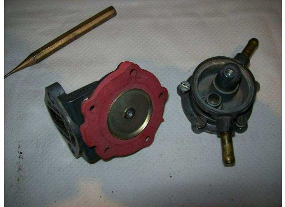
Ya solo nos queda montar el cuerpo superior sobre el inferior, la rejilla filtrante y la tapa con su junta...
