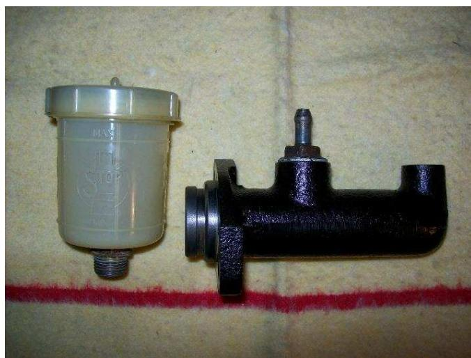
particularidad reside en que ya no lleva depósito, sino una rosca donde colocar un racor para un depósito externo o bien roscar un vaso al efecto, pudiendo usar la misma configuración que con la primera bomba.
