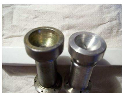
dimensiones internas normalizadas, distancias entre orificios, pasos de rosca, etc, hay algo que se diferencia entre fabricantes, y es la profundidad de la oquedad para el apoyo del empujador del pedal.
