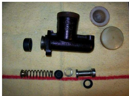
inferior puede observarse el émbolo con sus partes ordenadas en las posiciones que ocupan. Ahí tenemos el retén flotante del tipo “copela”, junto con una fina arandela de cobre que a su vez apoya en el émbolo. Esto conforma
