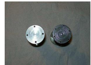
una especie de válvula que en el empuje del líquido, la arandela obtura los orificios del émbolo y al retroceder dejan pasar el líquido. Esto permite una recuperación más rápida de la bomba al estado de reposo, frente a un sistema algo más “perezoso” como el sistema de tambor frente al de disco. Esta es la famosa válvula a la que se refieren algunos recambistas al solicitarles una bomba.
